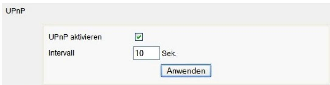
UPnP (Universal Plug and Play) dient zur herstellerübergreifenden Ansteuerung von Geräten über ein IP-basiertes Netzwerk. Bei der Premium-Web-Line wird es lediglich dazu verwendet, das Gerät im Netzwerk für PCs sichtbar zu machen.
